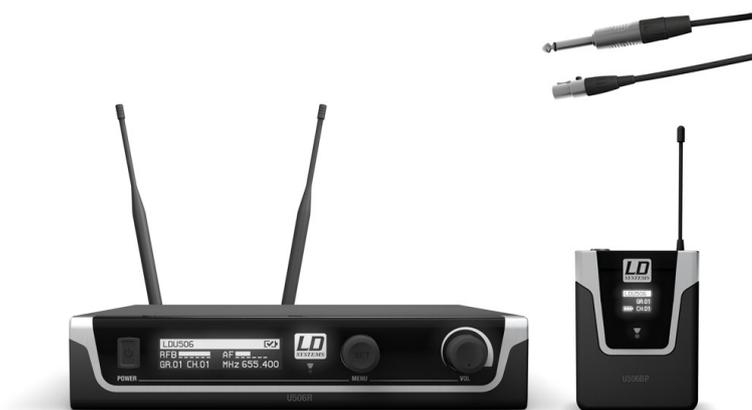
Micro sans Fil LD systems U506BPG avec jack pour instrument 655 - 679 MHz puissance 30mW
