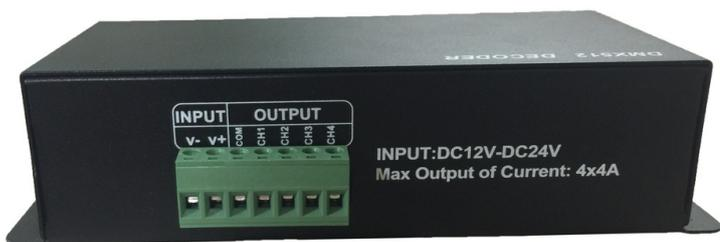
Driver de Led DMX 4 canaux pour RGBW Tapedriver HD 8A par canal
