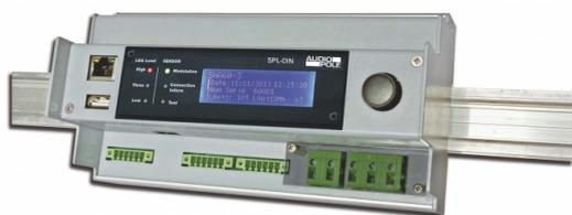
Limiteur de niveau sonore SPL-DIN Audiopole par coupure de prise de courant avec capteur et afficheur de dépassement
