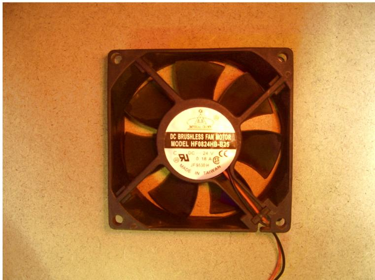
Ventilateur 80x80x25mm 24Vdc pour Beam 200 Acilite
