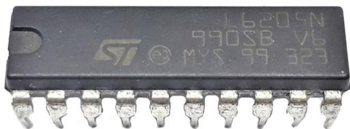
Driver de moteur type Beam 5R PAN TILT L6205N
