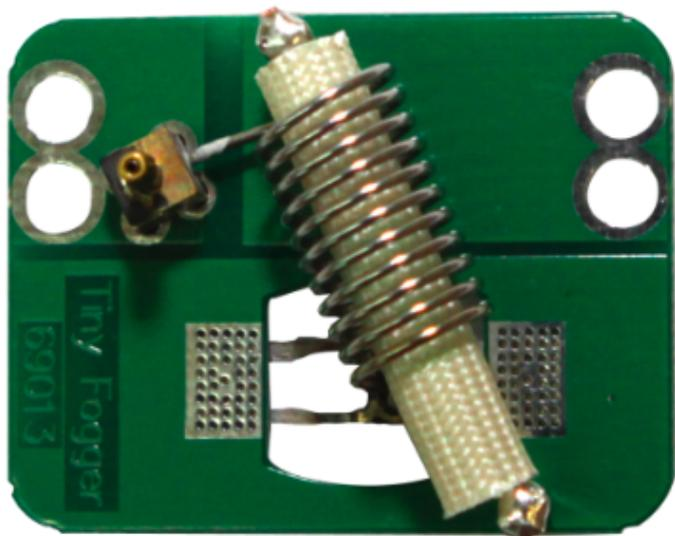
Corps de chauffe évaporateur Tiny FX et CX et Tiny F07 et C07
