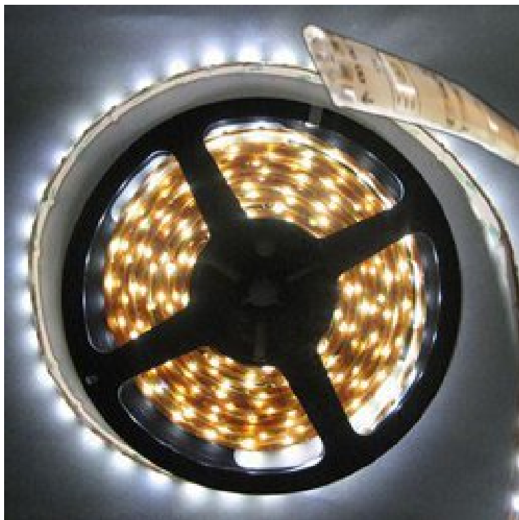
Ruban LED 24V Blanc Froid 6000K 60 LEDS 5050 900 lumens par metre IP65 Rouleau de 5m
