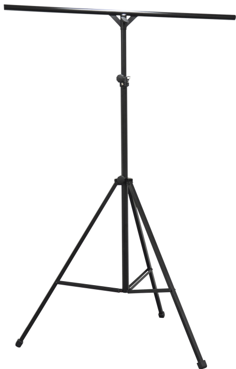
Pied Contest + barre tout métal hauteur 3m tube ø35 80Kg de charge
