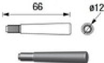
Goupille type AXE fileté M8 avec ecrou pour structure STACCO
