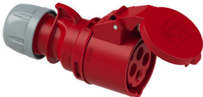
Prise P17 femelle 32A Triphasé 4 points IP44 Standard à vis
