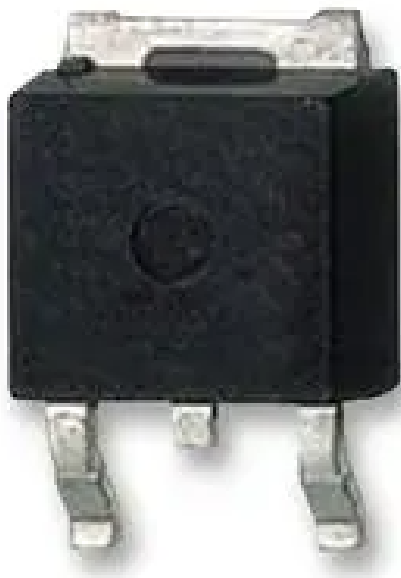
Régulateur de tension -8V 500mA MC79M08BDTRKG
