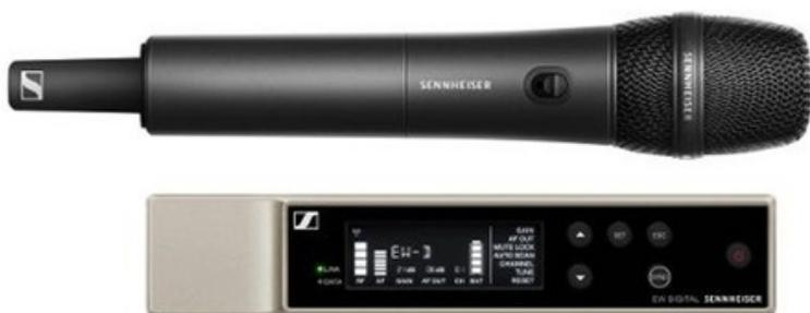
EW-D 935-S BASE SET (Q1-6) Sennheiser - Système micro main sans fil numérique avec capsule dynamique cardioïde 935 bande Q1-6
