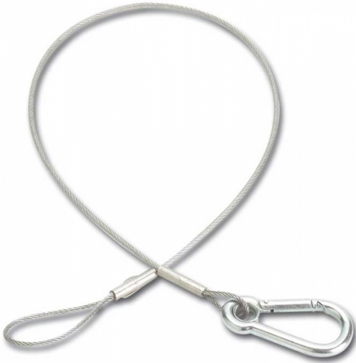
Elingue de sécurité CMU 70Kg cable 3mm longueur 60cm
