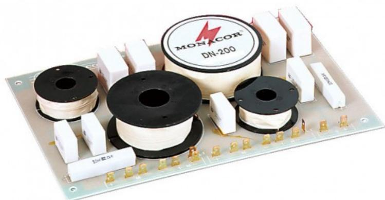
Filtre passif 3 voies 8 ohms 400W max
