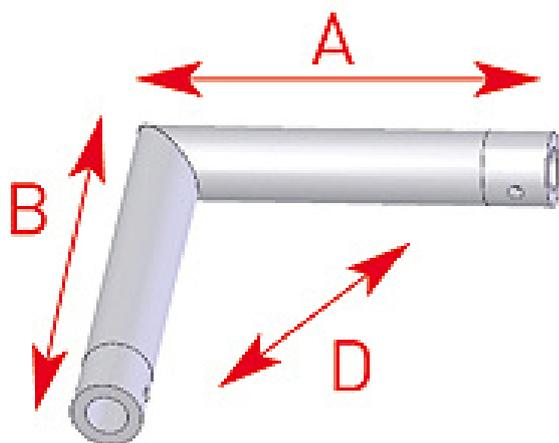
Structure Tube ASD - 57EX5022 / Angle 2 départs horizontal 90° - longueur 0,25 x 0,25 m
